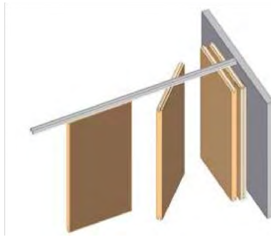
Sistema de apertura de paneles móviles acústicos
